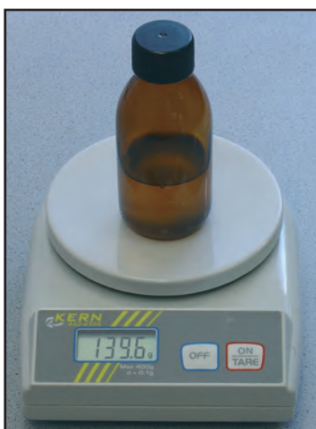
pesée du flacon contenant le liquide 2
