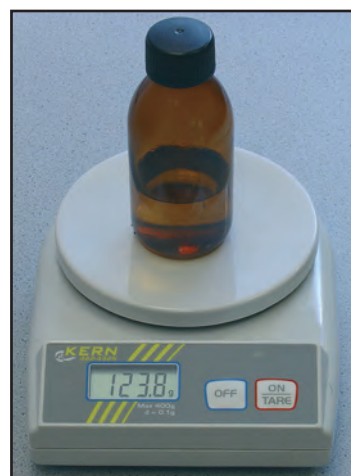
pesée du flacon contenant le liquide 3
