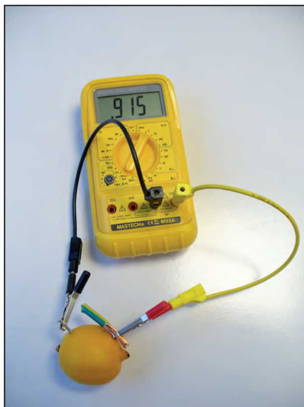
Fig. f62.2 La tension aux bornes de la pile au citron
