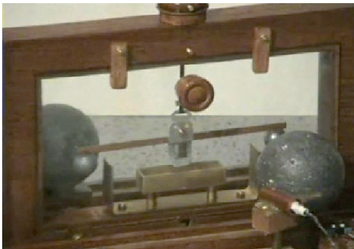
Fig. 1 La balance de torsion de Cavendish
